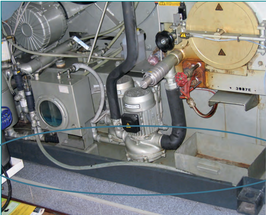
FOTO 3: CUBETA DE RETENCIÓN EN LA PARTE POSTERIOR DE UNA MÁQUINA.
