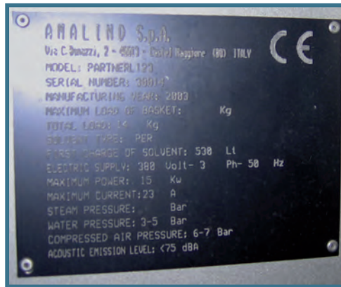
FOTO 2: PLACA DE CARACTERÍSTICA DE UNA MÁQUINA DE LIMPIEZA EN SECO.
